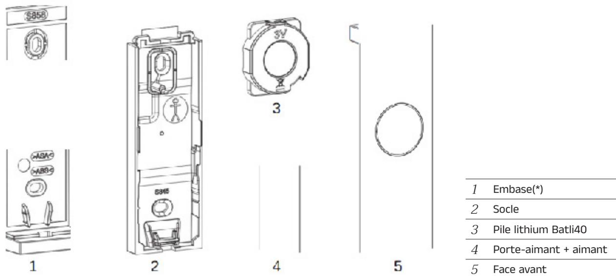
\* Pour répondre aux exigences de la norme EN 50131-2-6 pour les produits radio de grade 2 et améliorer leur tenue mécanique, le socle du détecteur 2 doit être fixe sur l'embase 1 à l'aide de vis à tête fraisée de Ø = 3 mm (non livrées).
