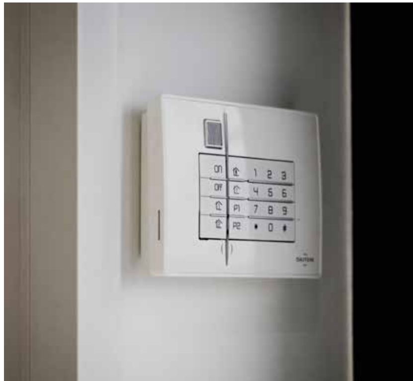
Sicher ist sicher: Die Code-Einrichtung der D20 quittiert Scharf- und Unscharfschaltung per Sprachausgabe.
